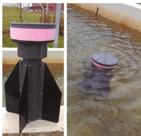
Imagen y esquema de los derivadores Langranianos utilizados. Dimensiones en milímetros.
