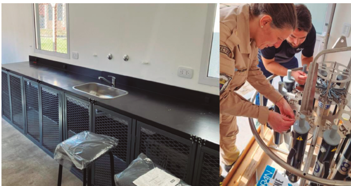
Izquierda: Interior del laboratorio móvil de la PNA. Derecha: Roseta de CTD y botellas de muestreo.
