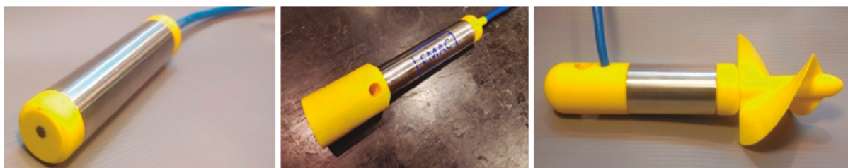
Ejemplos de sensores desarrollados en el proyecto. Izquierda: sensor de turbiedad. Centro: sensor de conductividad y temperatura. Derecha: correntómetro.
