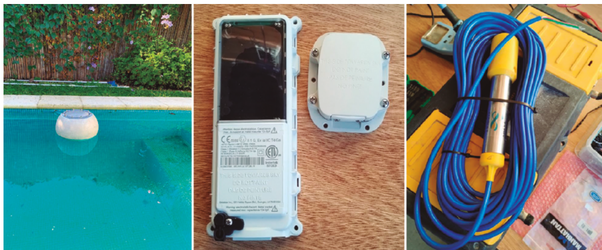
Izquierda: Boya con tapa estanca translúcida para albergar GPS con paneles solares. La boya fue diseñada y construida en el marco del proyecto. Centro: Dos tipos de GPS adquiridos en el marco del proyecto. Solar (izquierda) y Smart-C (derecha). Derecha: Sensores de temperatura y conductividad elaborados en el IADO (Bahía Blanca). Se adquirieron 10 en el marco del proyecto.
