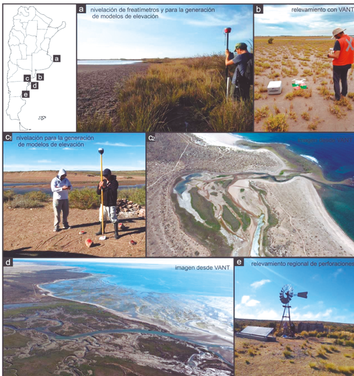
Fotografías mostrando: Tareas de nivelación de la red de monitoreo y de nivelación para la generación de modelos de elevación del terreno de alta resolución. Realización de vuelos con vehículos aéreos no tripulados (VANT). Relevamiento regional de perforaciones de agua ya existentes. Las fotografías corresponden a las áreas de: (a) Punta Rasa, (b) Bahía San Blas, (c) Puerto Lobos, (d) Riacho San José y (e) Bahía Bustamante.
