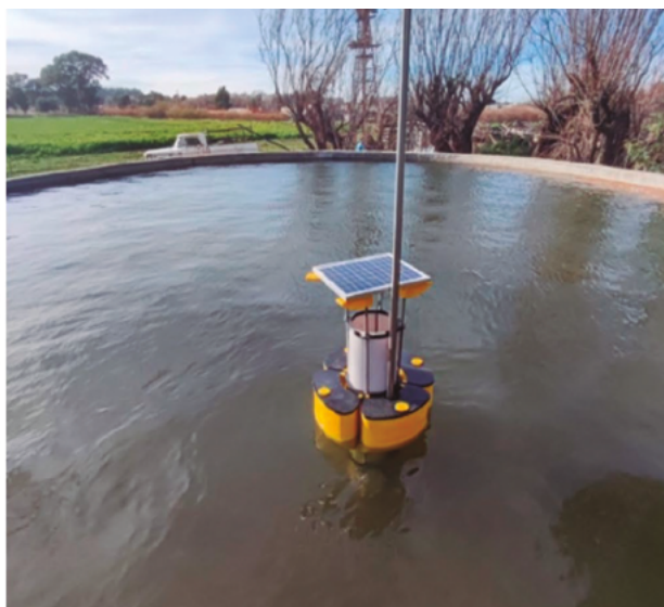
Izquierda: Boya prototipo durante el ensamblado en el laboratorio. Derecha: prueba de flotabilidad realizada el 10/08/22.
