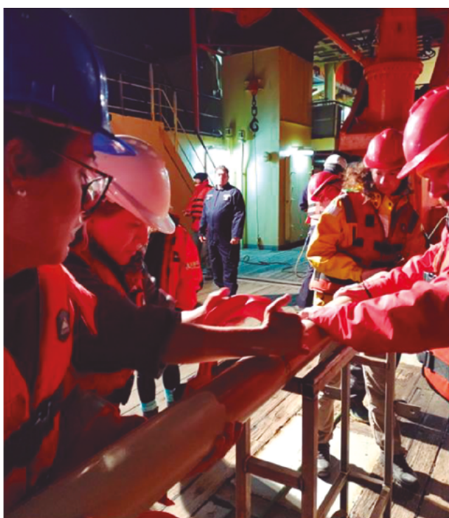
Equipo de sedimentos realizando el corte del testigo sedimentario
